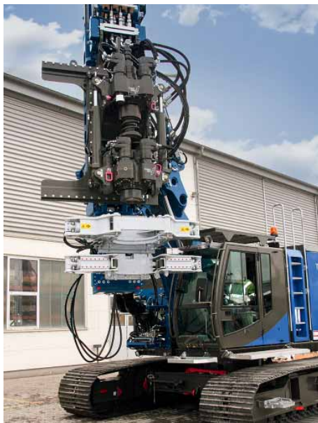
ABI MOBILRAM TM 17 mit einer Mikropfahl-Ausstattung, der Bohrantrieb kann seitlich aus der Bohrachse gefahren werden, die Klemm- und Brechvorrichtung dient zum Handling der einzelnen Mikropfahlsegmente.
