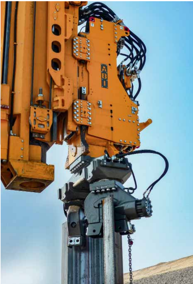
Mit einer Doppelklemmzange MZK kann die Kraft optimal auf Doppeldielen oder Rohre übertragen werden.
