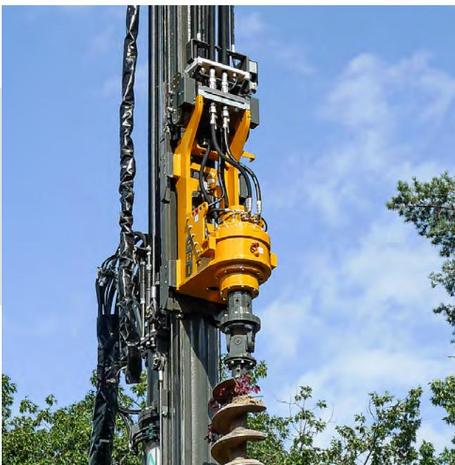
Der Bohrantrieb MDBA kann sehr vielseitig eingesetzt werden: Zum Vorbohren, SOB-Bohren sowie zum Bodenmischen.
