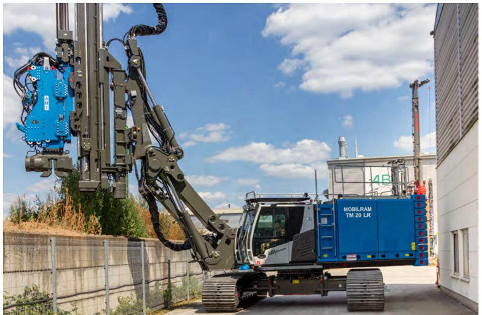
ABI MOBILRAM TM 20 LR - eine Maschine mit vergrößerter Reichweite, speziell konzipiert für Arbeiten unterhalb bzw. oberhalb des Arbeitsplanums, z. B. zum Einbringen von Rammelementen an Böschungen, an Straßen oder Autobahnen.
