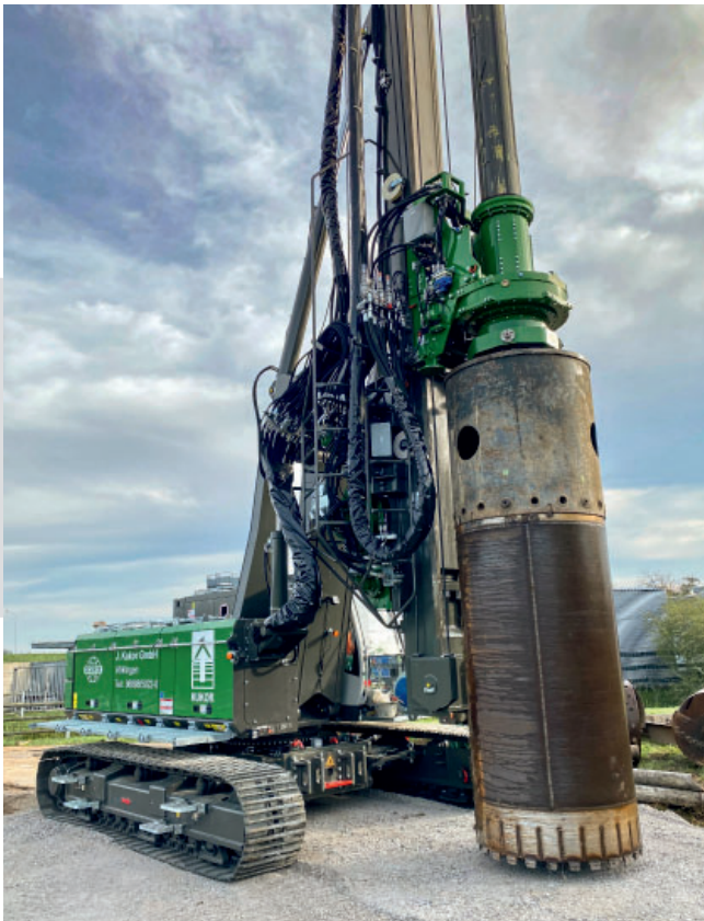
Der teleskopierbare Unterwagen ist mit mechanischen Anschlüssen für eine Verrohrungsmaschine (mit integrierter Steuereinheit) zum Einbringen der Verrohrung bei großen Durchmessern und schwierigen Bodenbedingungen ausgestattet.
