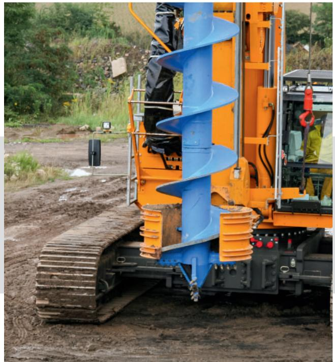
Die **Bohrwerkzeugführung** wird bei SOB- und VDW-Bohren sowie beim Bodenmischen zur Einhaltung der Vertikalität der Bohrung eingesetzt.
