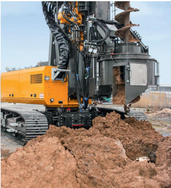
Beim SOB-Bohren ermöglicht der **Schneckenputzer** ein sicheres Reinigen der Schnecke und verhindert damit ein unkontrolliertes Herunterfallen des Bohrguts.
