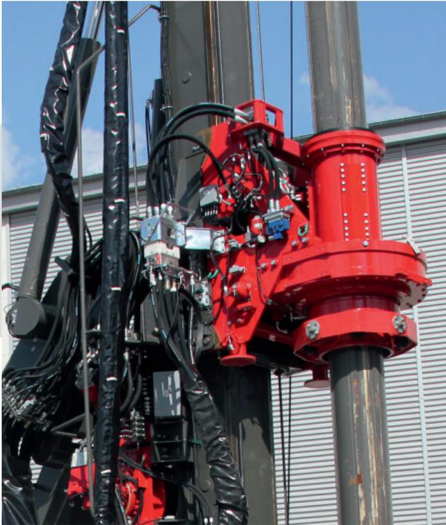
Das **Docking-System** ermöglicht ein schnelles Anschließen des Kellybohrantriebs. Die hydraulische Versorgung wird über ein Kupplungssystem mit Verriegelung hergestellt.
