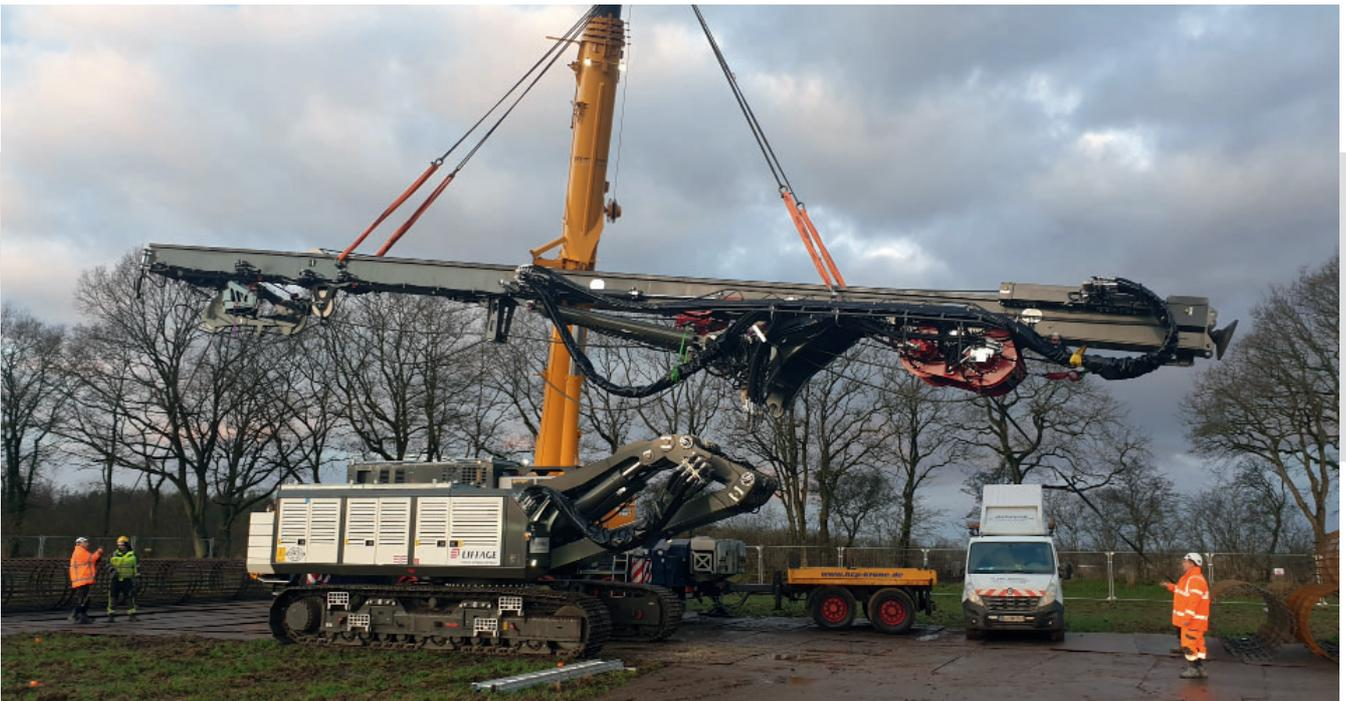
Demontage der Mäklereinheit bei einer Drehbohranlage mit teilbarer Schwinge. Um das Transportgewicht der Maschine zu reduzieren, kann die Mäklereinheit innerhalb bemerkenswert kurzer Zeit für den Transport demontiert werden.
