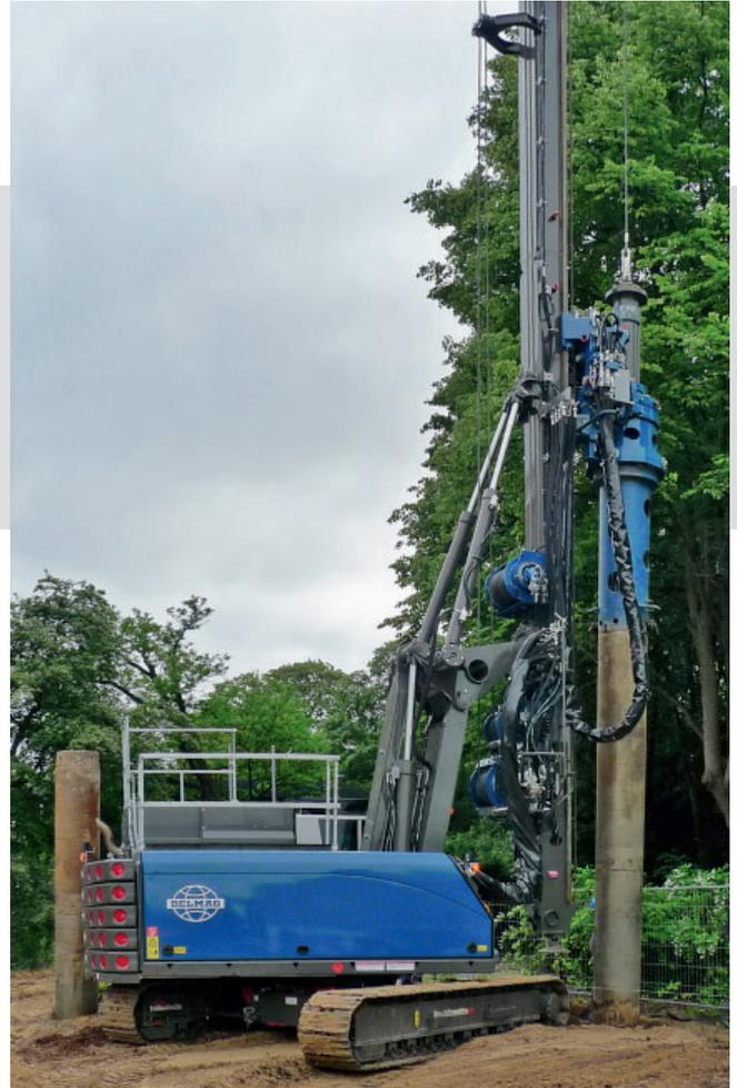
Das kleinste Modell der DELMAG Drehbohranlagen beim Kellybohren. Die Maschine kann mit Kellybohrantrieb und Kellystange transportiert werden.
