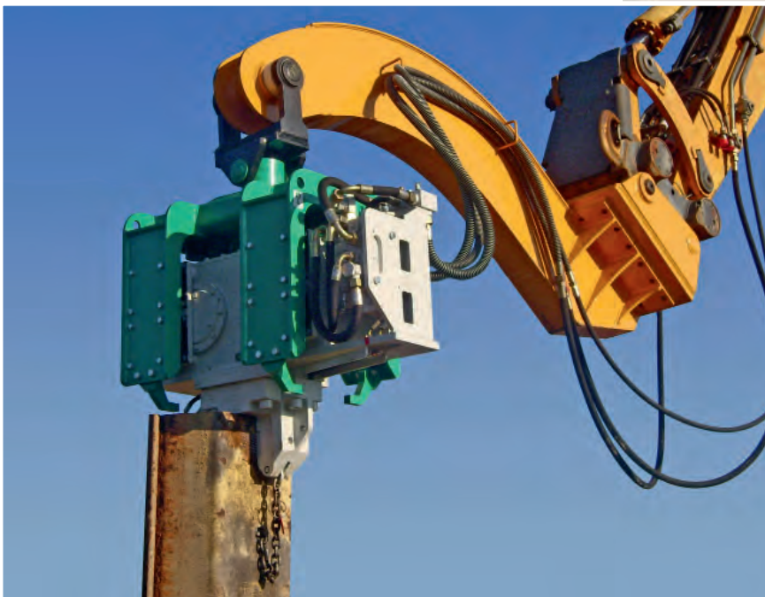
Bild: Anbauvibrator HVR 60 mit Löffelstielverlängerung und Schnellwechseleinrichtung
