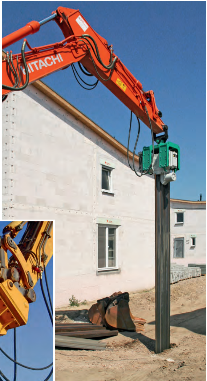
Bild: Anbauvibrator HVR 45 angebaut über Standard-Adapter
