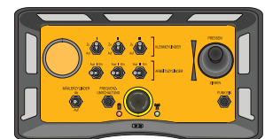
Für einen optimalen Arbeitsablauf wird das Hydro-Press-System über eine Funkfernsteuerung bedient.
