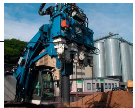
Die Anpassung an verschiedene Profilformen mit gleicher Verbaubreite erfolgt mittels Adaptern .
